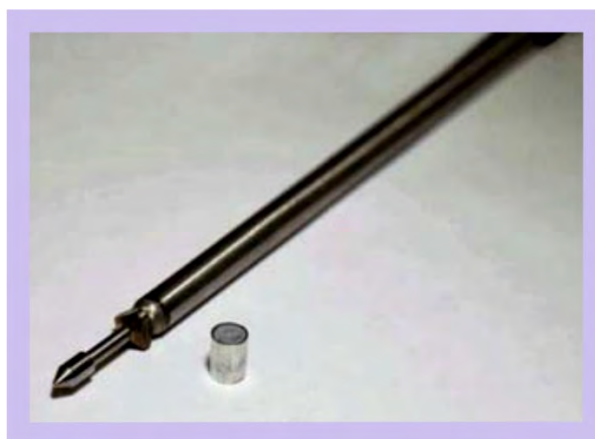
Рис. 4.2. Внешний вид мишени и кадмиевой капсулы со стартовой композицией
