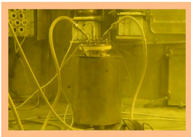
Рис. 3.3. Изображение аппарата во время окислительной обработки отработанного ядерного топлива
