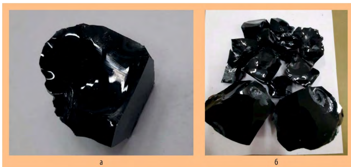
Рис. 3.11. Вид фрагментов боросиликатного стекла, извлечённого из тигля печи узла остекловывания
