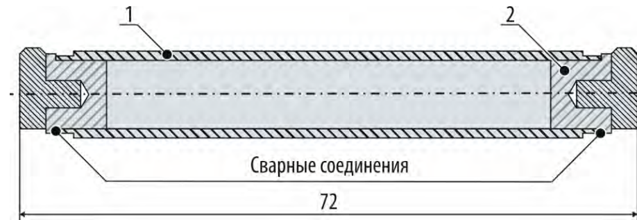
Рис. 2.37. Конструкция экспериментальной капсулы: 1 — оболочка; 2 — заглушка
