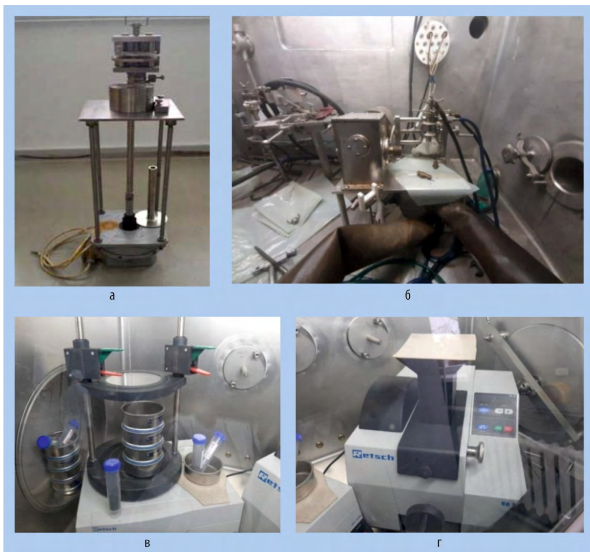
Рис. 1.15. Внешний вид установок: виброуплотнения (а), сварочной (б), отсева (в) и измельчения оксидов (г) в перчаточном боксе
