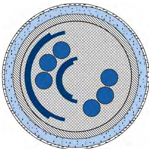
Рис. 1.50. Взаимное расположение твэлов и экранов при измерении относительной активности тепловыделяющих элементов
