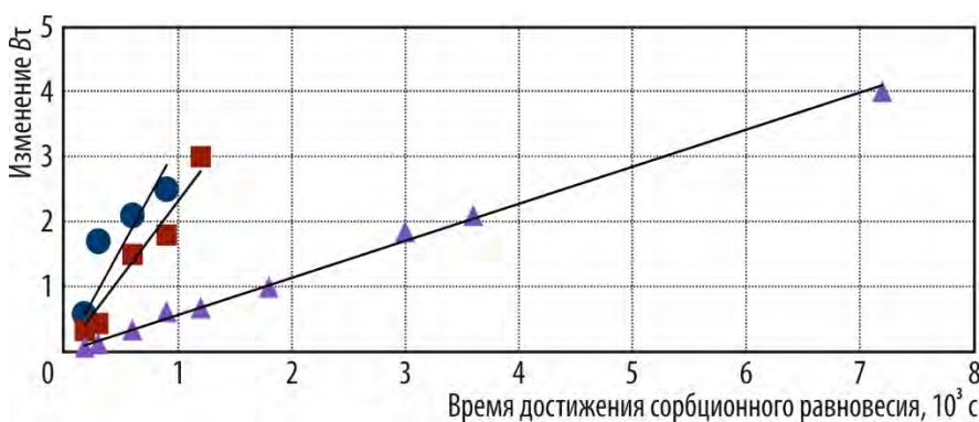
Рис. 4.9. Изменение кинетики B\tau сорбции ионов серебра в зависимости от времени для синтетического цеолита NaX с различным диаметром зёрен: 0,0050–0,0063 (●), 0,0063–0,0250 (■), 0,0250–0,3000 (▲) см
