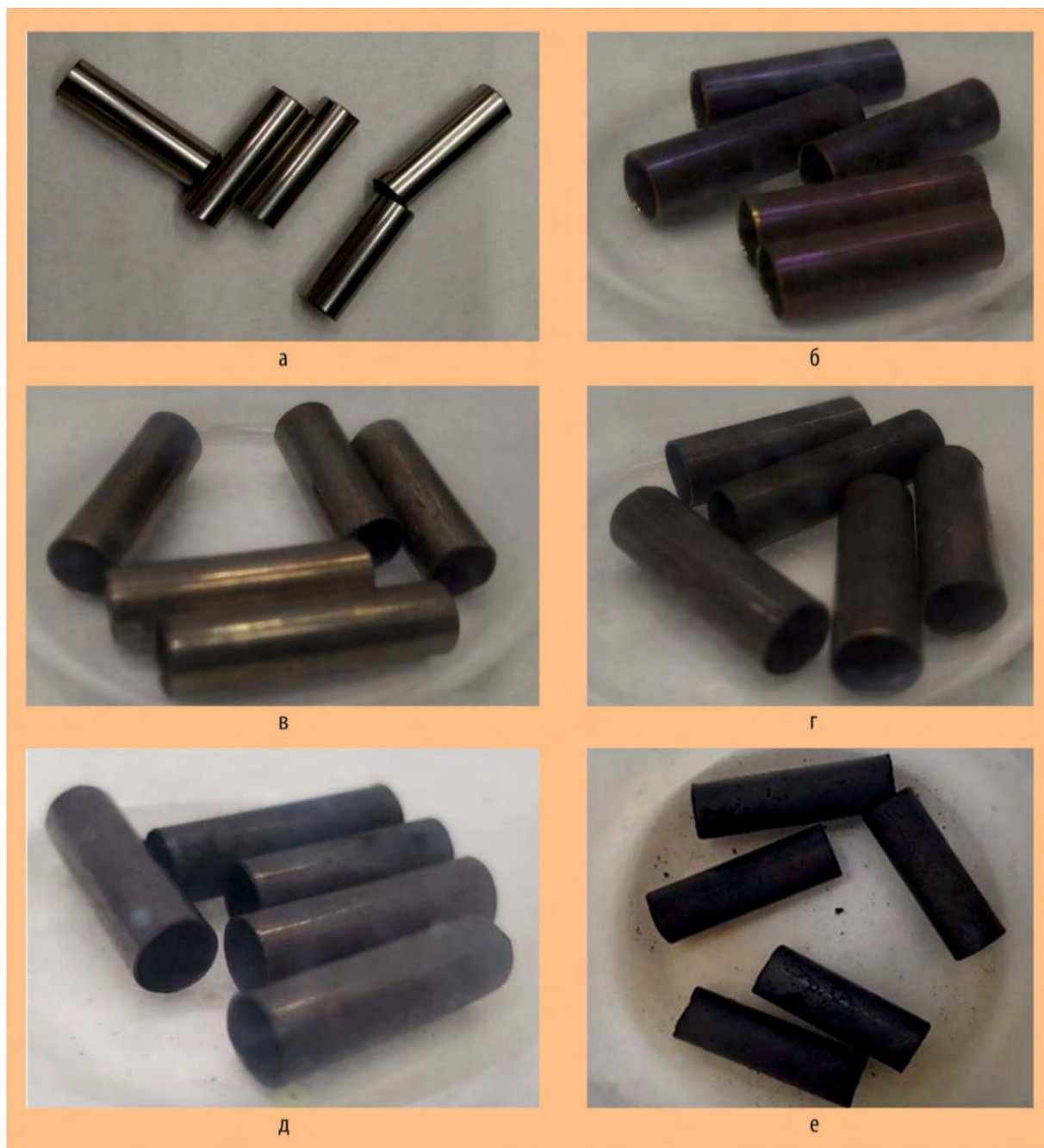
Рис. 3.2. Внешний вид оболочки исходного образца (а) и образцов после окисления при температуре, равной 400 (б); 500 (в); 600 (г); 700 (д); 800 (е) °С
