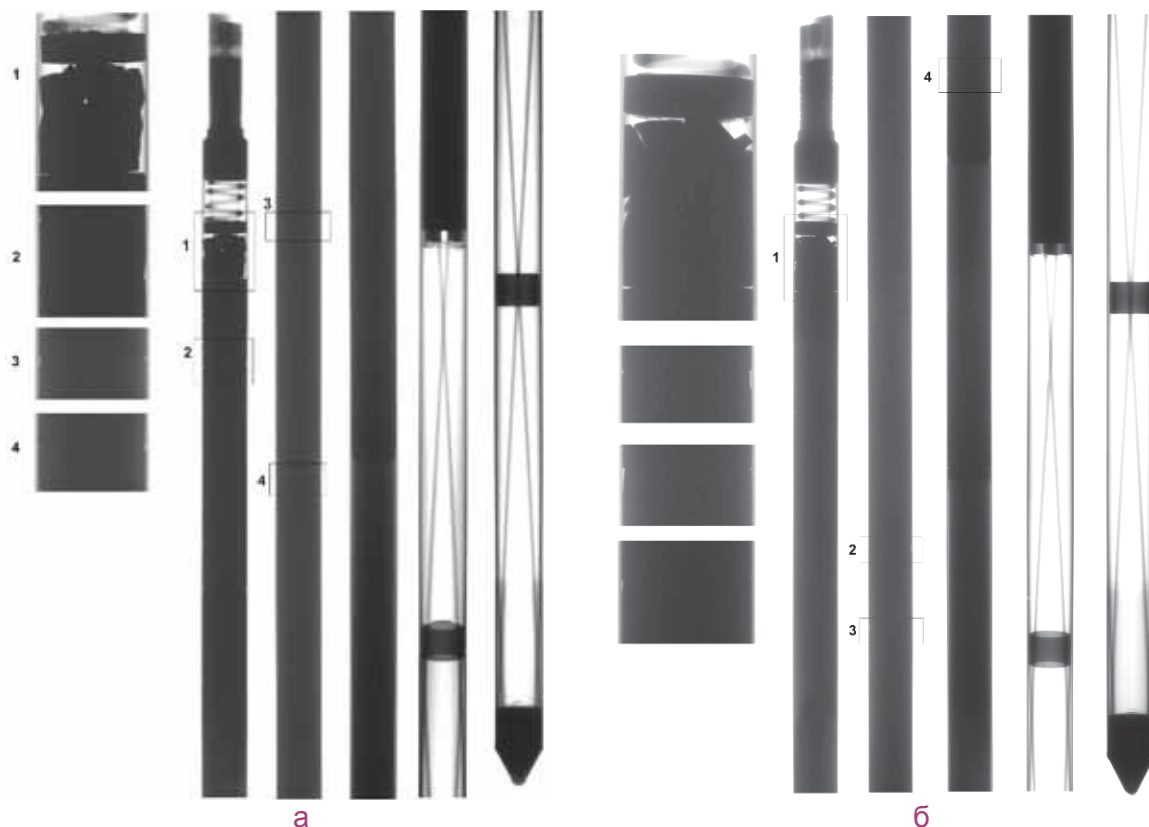
Рентгеновские снимки твэлов с топливным сердечником, изготовленным по нанотехнологии (а) и штатной технологии (б), где 1 — растрескавшаяся таблетка в верху топливного сердечника; 2–4 — дефекты на стыках топливных таблеток
