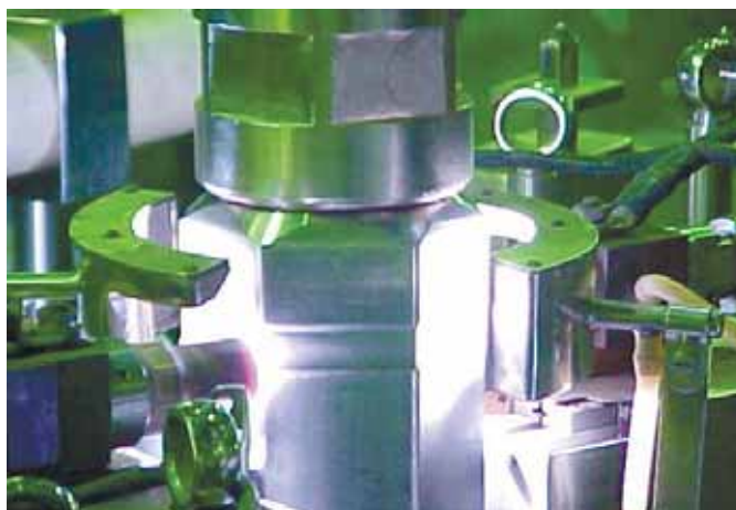
Приварка головки тепловыделяющей сборки
