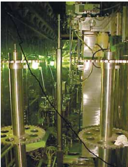
Автоматизированная машина изготовления ТВС
