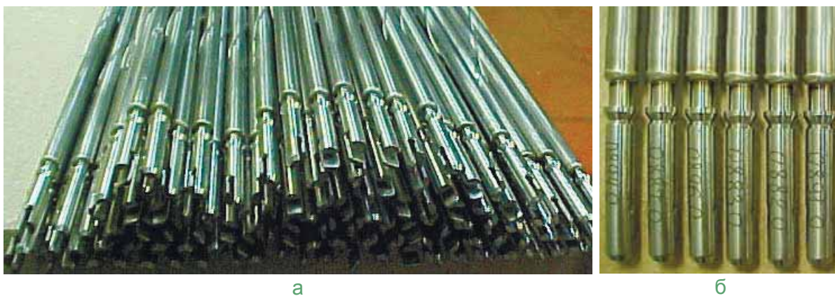
Внешний вид твэлов для гибридной активной зоны реактора БН-800: твэлы (а); маркировка твэлов (б)
