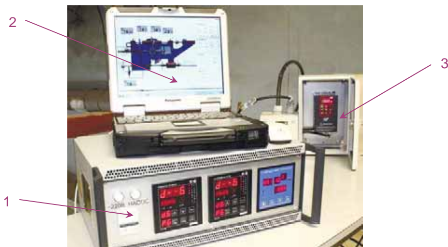
Внешний вид оборудования информационно-измерительной системы: 1 – крейт измерительный, 2 – промышленный ноутбук, 3 – коробка распределительная
