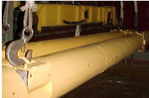
Отправка тепловыделяющей сборки на склад готовой продукции
