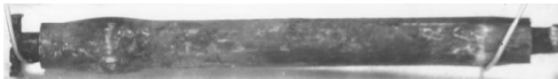
Рисунок 3 – Внешний вид облученного имитатора с оболочкой из сплава 42ХНМ
