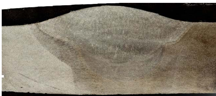
Рисунок 2. Макроструктура сварного соединения корпуса ОПГ-1.
