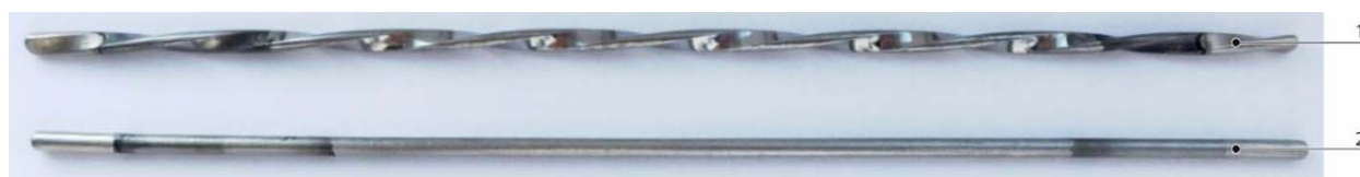
1 — цилиндрический образец; 2 — витой образец
